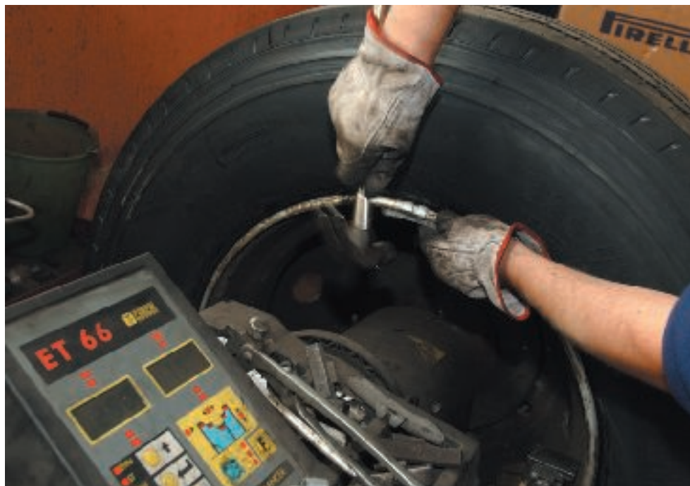
Utilizzando la bilanciatrice elettronica (ET 66 della Corghi), il gommista registra la necessità di inserire un peso da 50 grammi. Il lancio successivo dimostra che il bilanciamento è avvenuto
