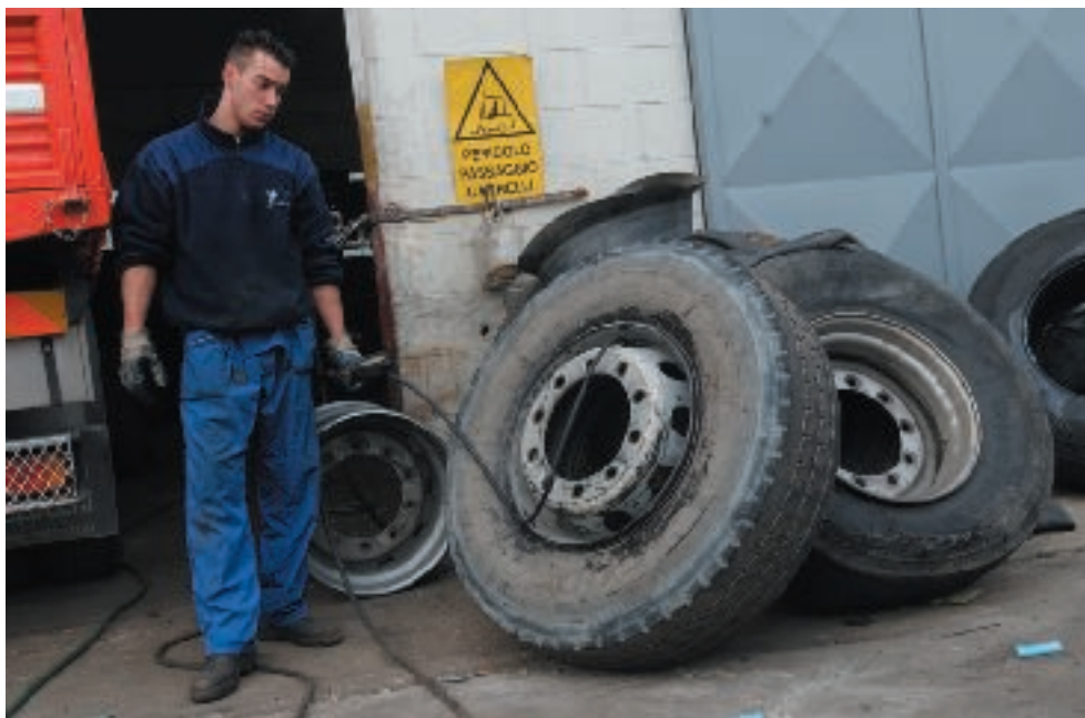
Il gonfiaggio del pneumatico: le pressioni in gioco ruotano attorno a un range di opportunità variabile dagli 8 agli 8,5 bar
