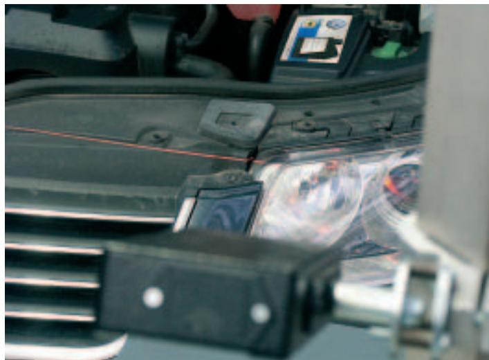
no in grado di venire incontro ai riparatori disegnando, sul lato esterno del fanale, una croce che indicava il centro della parabola. I costruttori di centrafari, da parte loro, dotavano i loro apparecchi di un'astina estensibile situata proprio nel mezzo della lente. Facendo coincidere l'estremità dell'astina, che fungeva anche da distanziometro, con il centro della croce, il centrafari era allineato.
