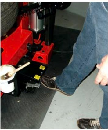
Il controllo dell'Artiglio 50 avviene per mezzo di pedali, per il sollevatore e il motoinverter, e di una consolle estremamente razionale e intuitiva nell'utilizzo.
