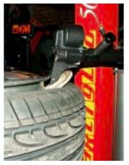
Il fissaggio al piano di lavoro rappresenta una vera rivoluzione rispetto ai tradizionali smontagomme. La maniglia di bloccaggio permette il rapido ancoraggio alla plattorello sottostante passando dal foro centrale del cerchio.
