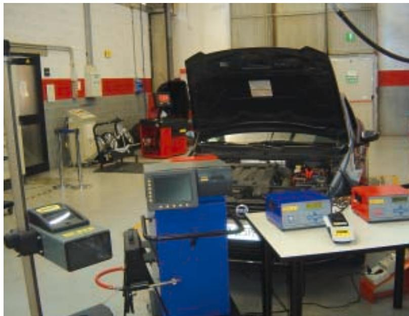
Sopra, una piccola parte degli strumenti Corghi per il mondo dell'officina. Da sinistra il centralfari, l'analizzatore gas, i caricabatterie e il tester per batterie.
