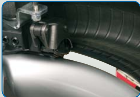
➤ Standard bottom bead demounting procedure with mount/demount head Procedimiento estándar de desmontaje del talón inferior con torreta
