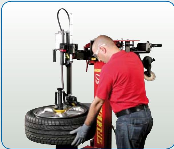
➤ Top bead demounting procedure. Procedimiento de desmontaje del talón superior.
