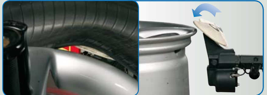
➤ Rapid bottom bead demounting procedure with bead breaker disc (particularly useful with stiff sidewalls) Procedimiento rápido de desmontaje del talón inferior mediante disco destalonador (especialmente indicado para lados duros)
